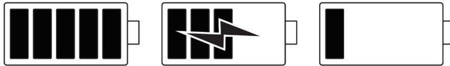
Es wird empfohlen, dass Sie Ihr Gerät aufladen, wenn der Akkustand unter 40% der Kapazität fällt.
